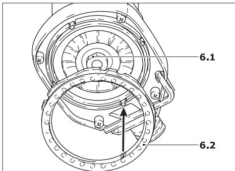
Le patin de ponçage est bloqué par une collerette (6.2) afin d'éviter qu'il ne monte de façon incontrôlée. La collerette étant soumise à l'usure dans le temps, l'effet de blocage s'affaiblit, et elle doit être remplacée par une neuve (référence 453 388).
